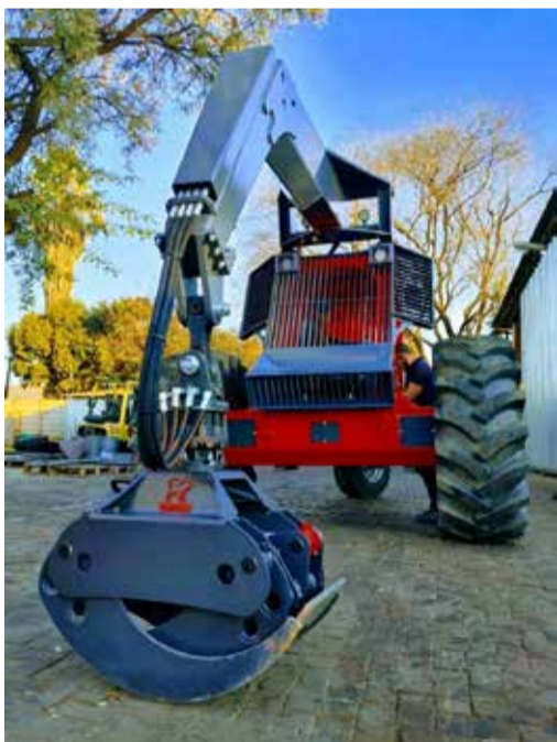
'n Stomphanteerder word gebruik vir die laai en hantering van hout in die bosboubedryf.
