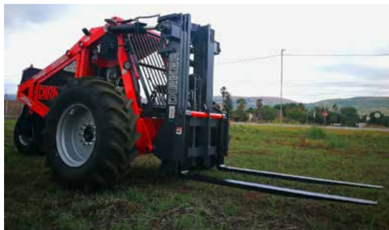
Die vorkhyser word aangewend vir die hantering van goedere op enige rowwe terrein.
