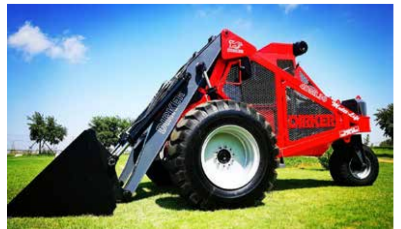
Multi-hyser is 'n veeldoelige masjiene. Dit is 'n vorkhyser- en laaigraafkombinasie.
